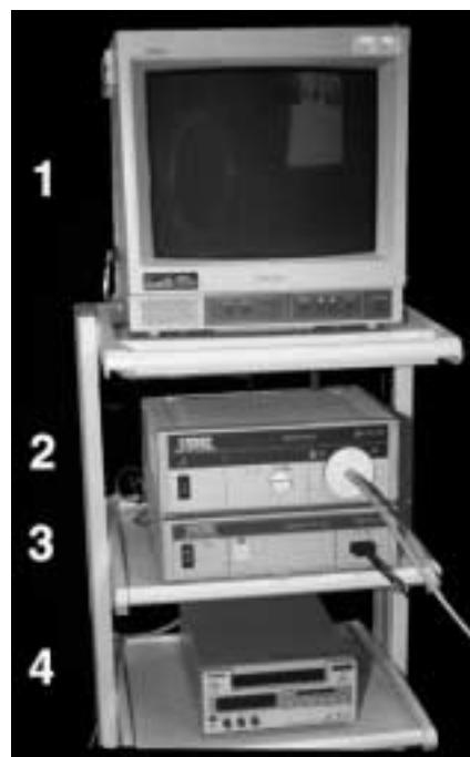
Abb.1 Multimediabil mit den von uns verwendeten Geräten (siehe Text). 1= Videomonitor; 2= Kaltlichtquelle; 3= Kamera-Kontrolleinheit; 4= Digitaler-Videorekorder.
