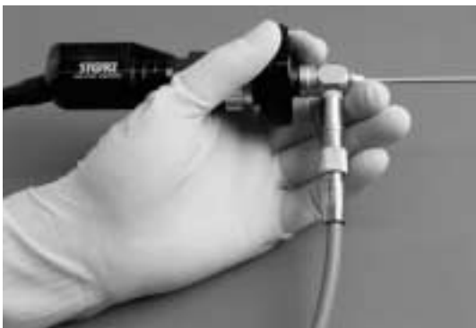
Das Endoskop mit dem zuführenden Lichtleiter unten und dem Kamerakopf links wird mit einer Hand gehalten und geführt.
